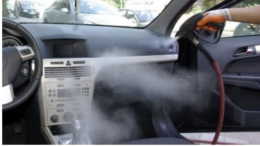
Şekil 3. Buharlı temizleme yöntemiyle havalandırma kanallarının temizliği
